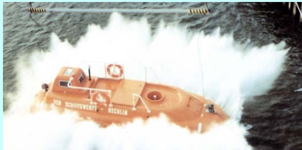
Schiffswerft Rechlin - GAL-Boot beim Eintauchen in das Wasser
