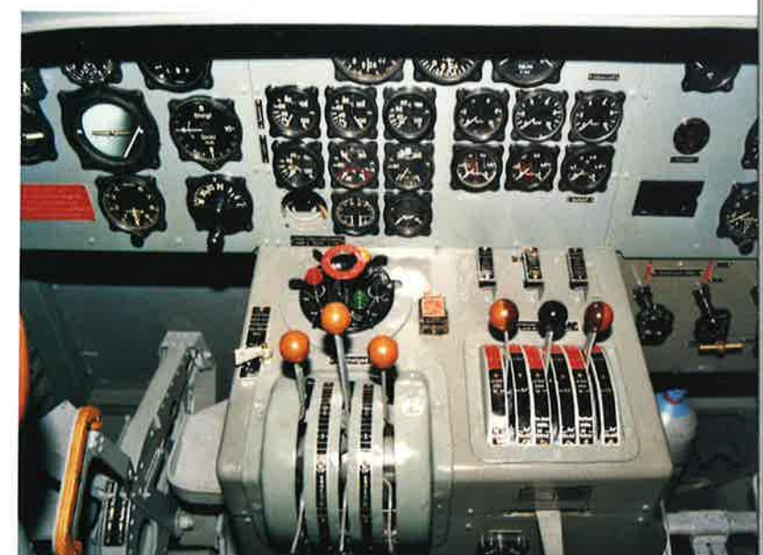
Das restaurierte Cockpit mit Instrumenten aus den Jahren 1939 / 40
